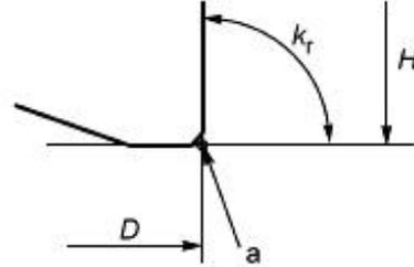
в) Пластина с торцовой режущей кромкой и фаской на вершине
