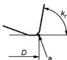
в) Пластина с торцовой режущей кромкой и фаской на вершине
