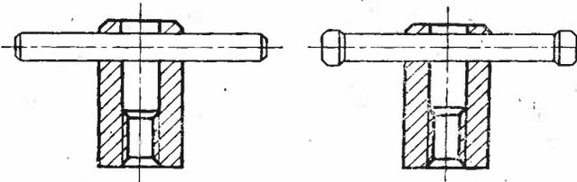
**Изменение № 2 ГОСТ 13427—68 Гайки с отверстием под рукоятку для станочных приспособлений. Конструкция и размеры**
