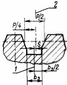
Положение оси симметрии канавки: 1 — действительное.
