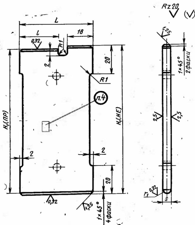
Примечание. Допускаются отверстия диаметром 3—5 мм (указаны штриховой линией) при обработке заготовок пакетом и для подвешивания.
