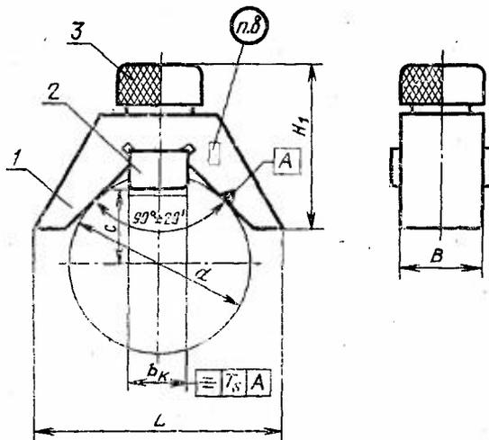
1 — корпус; 2 — шпонка; 3 — гайка
