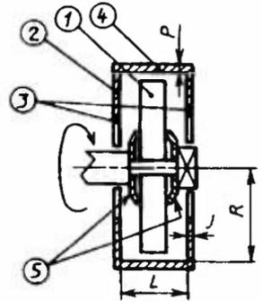
1 — шлифовальный круг; 2 — защитный кожух; 3 — боковые стенки кожуха; 4 — периферическая часть кожуха; 5 — фланцы;  $P$  — толщина периферической части кожуха;  $J$  — толщина боковых стенок кожуха;  $L$  — ширина кожуха;  $R$  — внутренний радиус кожуха
