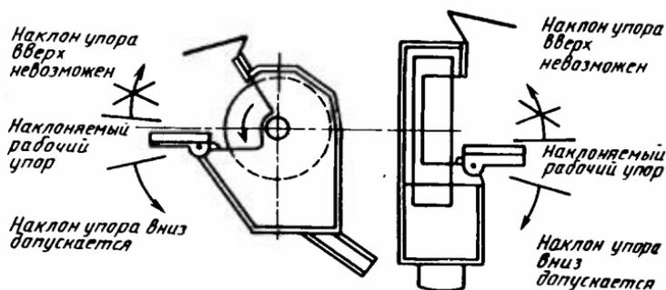
Рисунок 105 — Настольная шлифовальная машина с наклоняемым рабочим упором
