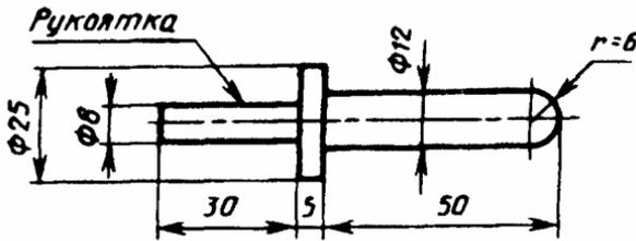
Рисунок 101 — Испытательный щуп "а"
