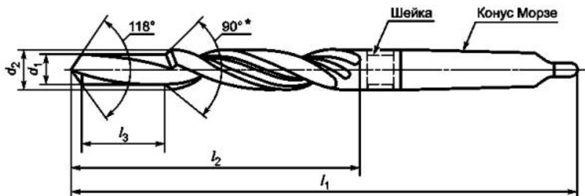
\* Допускается изготовление сверла с углом 120°.
