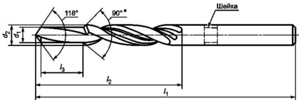
\* Допускается изготовление сверла с углом 120°.
